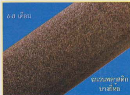
รูปที่ 2 จากการทดสอบโดยการนำไปตากแดด ตากฝน ภายใต้บรรยากาศจริงในประเทศไทย พิสูจน์ให้เห็นว่าฉนวนเซลแฟล็กซ์มีความทนทานต่อสภาวะอากาศต่าง ๆ ได้ดีกว่าฉนวนพลาสติกและฉนวนบางชนิดอื่น ซึ่งแตกเป็นลาย หรือเป็นผง และเสื่อมสภาพเป็นฉนวนที่ดีภายในระยะเวลาอันสั้น
