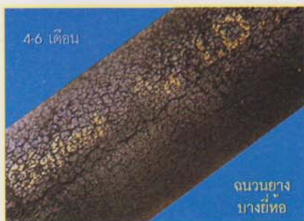
รูปที่ 2 จากการทดสอบโดยการนำไปตากแดด ตากฝน ภายใต้บรรยากาศจริงในประเทศไทย พิสูจน์ให้เห็นว่าฉนวนเซลแฟล็กซ์มีความทนทานต่อสภาวะอากาศต่าง ๆ ได้ดีกว่าฉนวนพลาสติกและฉนวนบางชนิดอื่น ซึ่งแตกเป็นลาย หรือเป็นผง และเสื่อมสภาพเป็นฉนวนที่ดีภายในระยะเวลาอันสั้น
