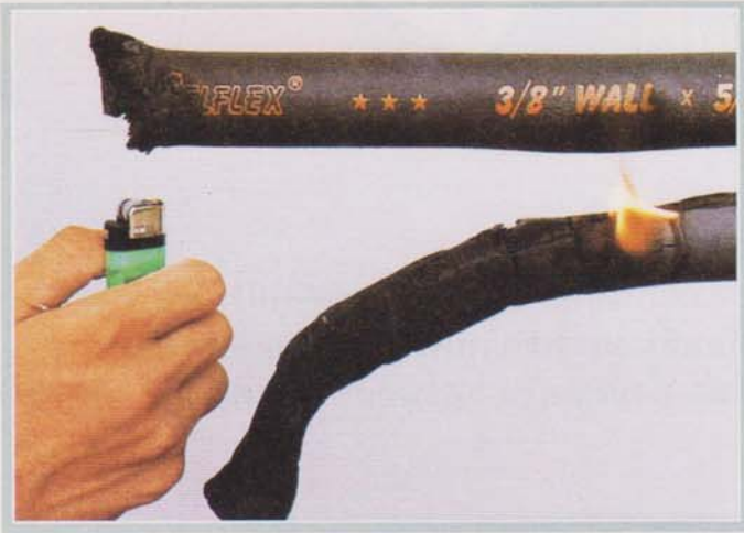
รูปที่ 1 การทดสอบการติดไฟโดยใช้ไฟแช็คจ่อเป็นเวลา 15 วินาที แล้วนำไฟออก จะเห็นว่าเซลแฟล็กซ์เป็นฉนวนชนิดไฟดับได้เอง ขณะที่ฉนวนบางชนิดอื่นจะติดไฟและลามไฟ อาจเป็นสาเหตุการเกิดเพลิงไหม้ได้
