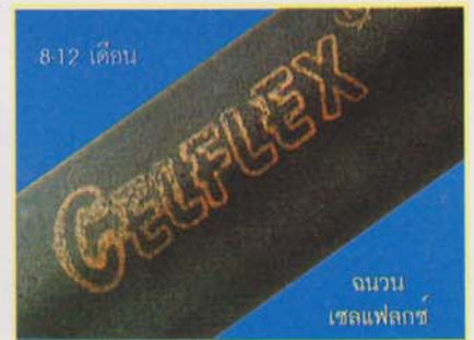
รูปที่ 2 จากการทดสอบโดยการนำไปตากแดด ตากฝน ภายใต้บรรยากาศจริงในประเทศไทย พิสูจน์ให้เห็นว่าฉนวนเซลแฟล็กซ์มีความทนทานต่อสภาวะอากาศต่าง ๆ ได้ดีกว่าฉนวนพลาสติกและฉนวนบางชนิดอื่น ซึ่งแตกเป็นลาย หรือเป็นผง และเสื่อมสภาพเป็นฉนวนที่ดีภายในระยะเวลาอันสั้น
